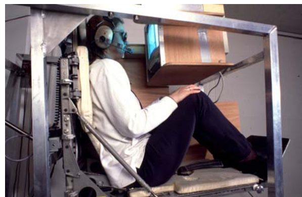
Proefpersoon tijdens een visueel-vestibulaire interactietest. Het frame wordt heen en weer bewogen op een sledebaan.
